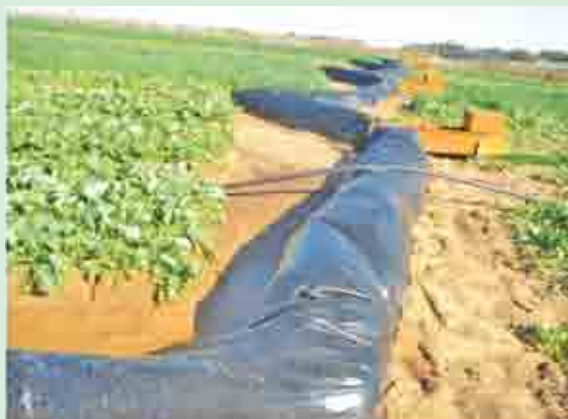
תמונה מס' 1: מערך מדידת נגר עילי בניסוי. מבט צד על מתקני המדידה בטיפולים השונים. שימו לב לשטח האיגום הנתחם בסוללות קרקע מחופות ניילון שחור ומזרמים מסוג HS במוצא האיגום
