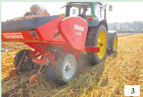
תמונה מס' 3: מזרעת תפוז"א GRIMME GL32B עם מנגנון זריעה אנכי. 3א. דיסק ופולח קבוע עם חצי אזמל; 3ב. דיסקים קעורים לכיסוי
