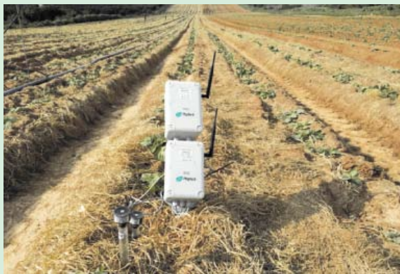
תמונה מס' 3: תחנת מדידה רציפה לאורך כל עונת הגידול של טמפ' קרקע ולחות, משמרת, עונת 2014-15
